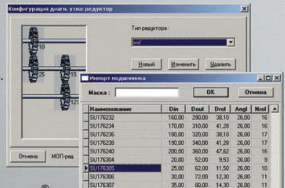
Предполагается два способа конфигурации. Описание параметров измерений, или описание параметров машины (типов подшипников, редукторов и т.п.).
