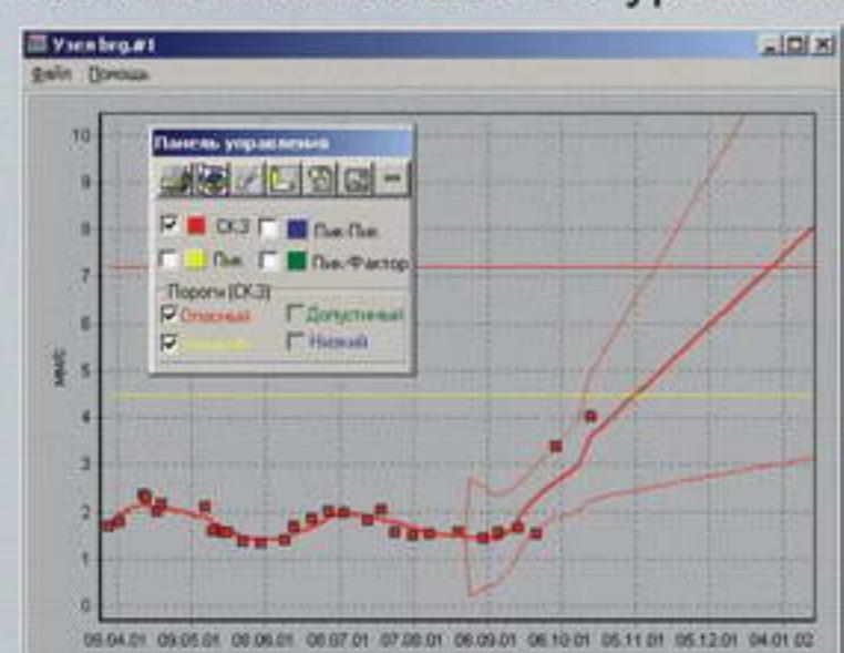
ренной на подшипниковой опоре. Тренд развития дефекта прогнозирует превышение высокого порога в течение недели и опасного порога в течение месяца.
